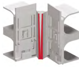
HZ vnitřní rohová objímka po instalaci potrubí (IE SCH 0002) pro vnitřní rohové tvarovky Pozor: instalujte širší stranou nahoru, protože vedení probíhá kónicky.
