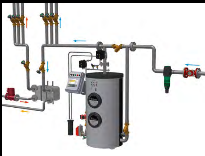
Funkční schéma vodovodní instalace s BIOCAT KS 14000
